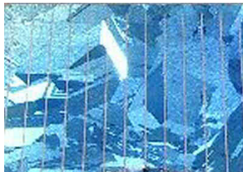
Darstellung 8: Polykristallin-Silizium Solarzelle.
